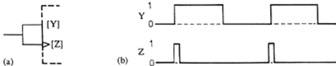
Figuur A.51. Tijddiagram voor een statische [Y] en een dynamische ingang [Z].
