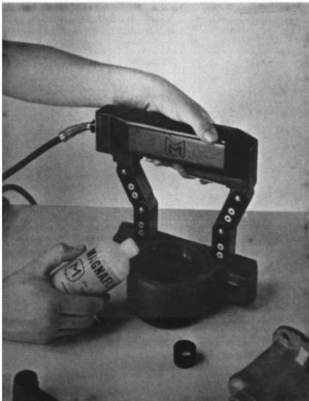
Figuur 3.18. Elektromagneet (juk) met verstelbare poten (verlengstukken van de kern). (Afgestaan door Magnaflux Corporation)
