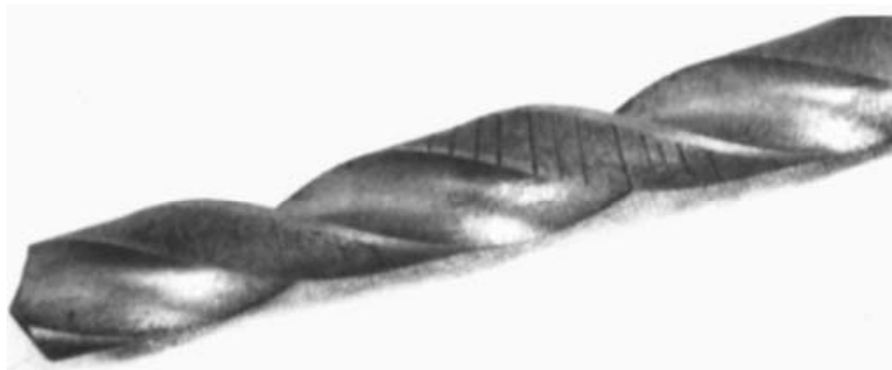
Figuur 3.14. Dwarsscheuren in een boor. (Afgestaan door Magnaflux Corporation)
