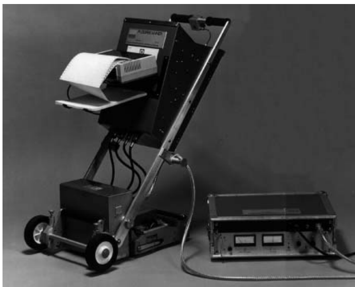
Figuur 3.27. Apparatuur voor het aantonen van putcorrosie in een bodemplaat (afgestaan door RTD b.v. te Rotterdam).
